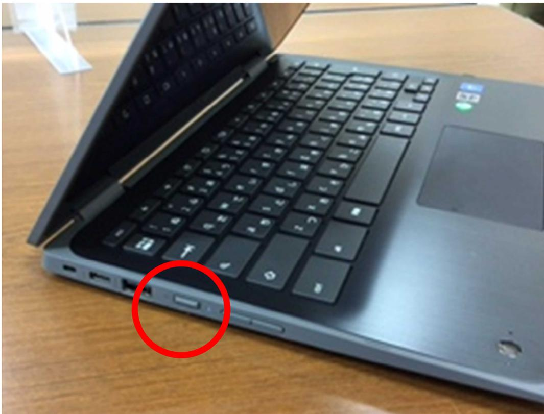
上記の写真は、タブレット端末右側側面です。上記の赤丸の部分が本体電源になっています。このボタンを長押し（3秒）すると、電源が切れます。何か、不具合が起きた場合や電源を確実に切りたいときにお使いください。
